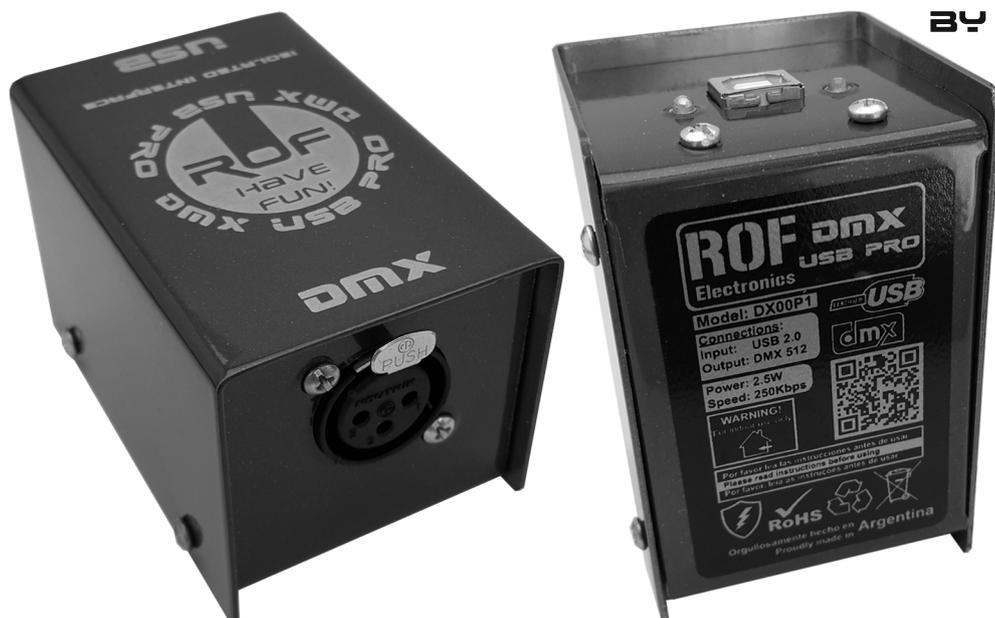
**DMX USB PRO** es una interfaz diseñada para el control de dispositivos mediante el protocolo DMX. Compatible con una gran cantidad de software, **DMX USB PRO** es la interfaz profesional ideal para el control de sus luces y dispositivos en sus espectáculos.
